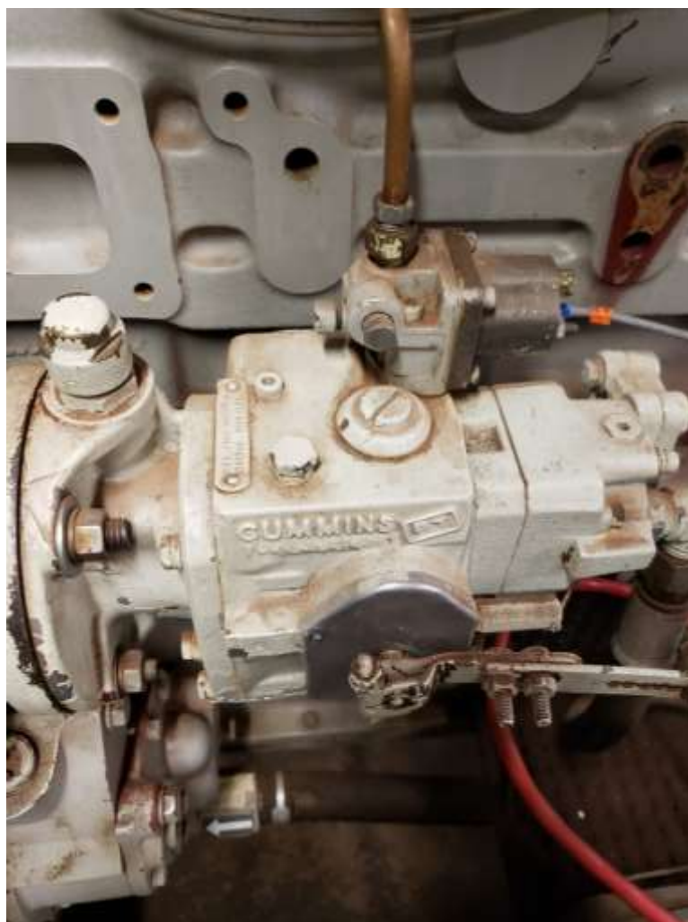
Foto 36: Detalhe da bomba injetora de combustível.
