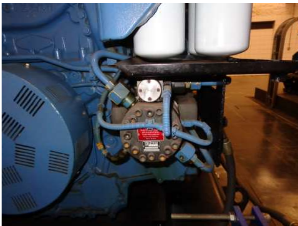
Foto 8: Detalhe da bomba de combustível de alta pressão (L'Orange) de um motor diesel MTU.
