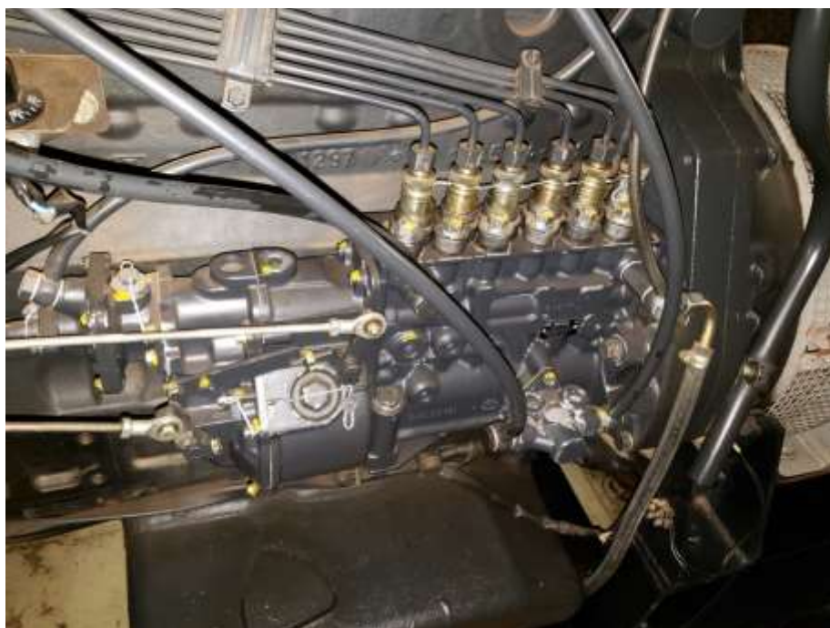
Foto 60: Bomba injetora Bosch do motor.
