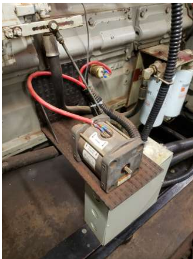
Foto 37: Detalhe do atuador angular.
