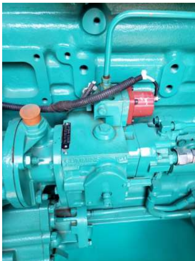
Foto 49: Bomba injetora e solenoide de corte de combustível.
